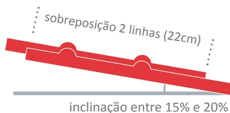
Para instalações sobre suportes descontínuos, fixar sempre a sobreposição sobre o suporte.
